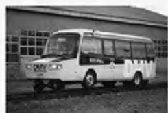
デュアル・モード・ビークル (線路と道路の双方を走る ことのできる車両)
